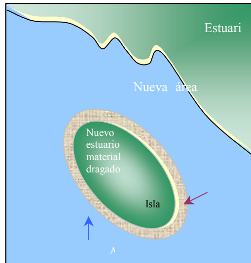
Figura 7. Esquema de la isla formada del material de dragado contenida por el geotubo
